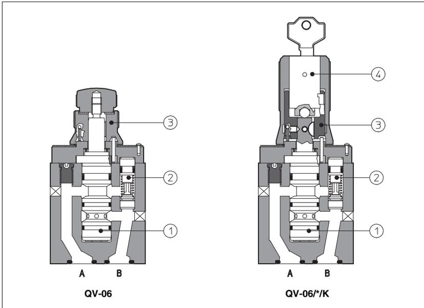
Le valvole **QV** sono valvole di controllo portata con compensatore di pressione ①: la portata regolata è indipendente dalle variazioni di pressione.
